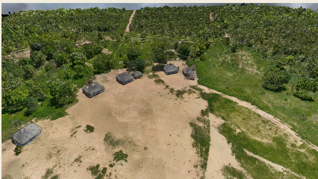
Figura 5: Imagem gerada a partir da nuvem de pontos coletada pela ForLiDAR em 2025.
