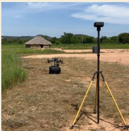
Figura 3: Drone DJI Matrice 350 RTK equipado com sensor LiDAR DJI Zenmuse L2 durante os preparativos para o levantamento de dados LiDAR em áreas de preservação permanente (APPs) pela ForLidar 2025.
